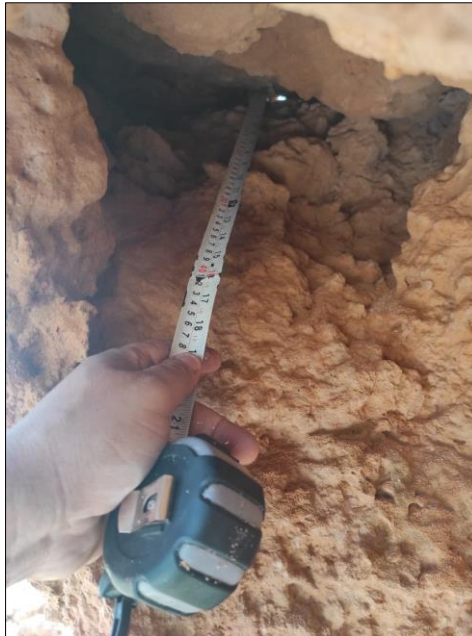
المصدر: العمل الميداني في المدة من ٥ - ٨ أغسطس ٢٠٢٢ كهف ٢ ٣١ ٣٧ ٢١.١١ ش ٢٥ ٥٥ ٤٤.٧٠ ق صورة (١٧) قصبه أحد الثقوب الإنفجارية، القياس من داخل الكهف
